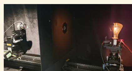
設置參考光度計以測量光源的光強度。
