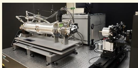
標準及校正實驗所低溫輻射計和陷阱輻射計的示範。
